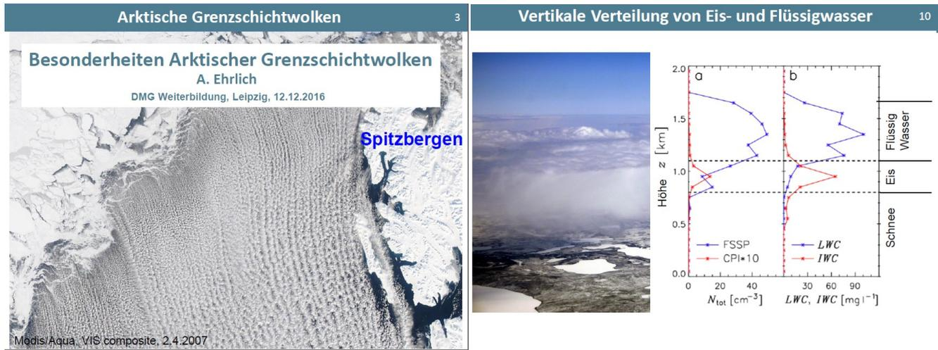
Der in der Arktis häufigste Wolkentyp sind arktische Grenzschichtwolken. Diese Mischphasenwolken bestehen aus einer Anzahl  $N_{tot}$  von wenigen Eiskristallen (CPI) und vielen Wassertröpfchen (FSSP). Die Masse der wenigen Eiskristalle (IWC) ist aber mit der Masse des Flüssigwassers (LWC) vergleichbar.
