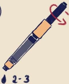
Nach vollständigem Befüllen 2-3 Tropfen zurückfließen lassen. So kann später durch Druck- oder Temperaturschwankungen keine Tinte austreten.
