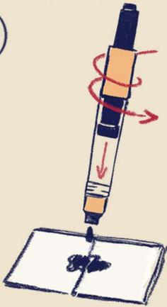
Durch Linksdrehung den Kolben vollständig Richtung Öffnung herausdrehen.
