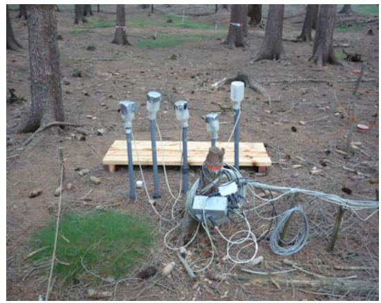
Bodenfeuchtemessungen (Tensiometer) an der Ankerstation Tharandter Wald
