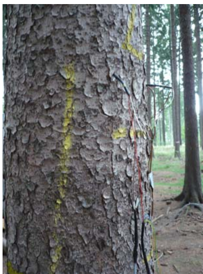
Sensoren zur Saftstrommessung über Temperaturdifferenzmethode nach Granier (Thermoelemente) an der Ankerstation Tharandter Wald
