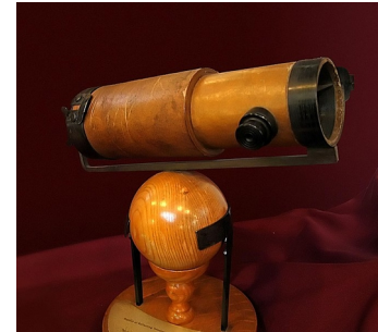
Spiegelteleskop nach Newton (1668)
