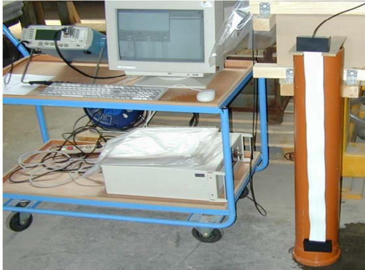
**Bild 2:** TDR-Versuchsstand mit Kabelsensor, Kabeltester und DV-Einheit
