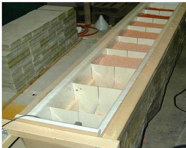
**Bild 8:** Trog mit Kabelsensor und Kammern für Materialien unterschiedlicher Feuchte
