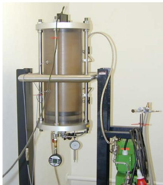
**Bild 10:** Druckversuchsstand zur Detektion von Feuchtefronten im Bentonit; links schematische Darstellung der Befüllung
